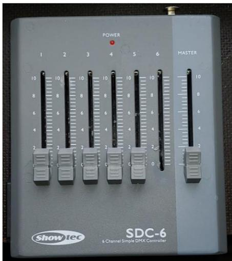
Kanal 1-4 regeln die Scheinwerfer (Dimmer); der Master ganz rechts im Bild dient als Hauptschalter.
